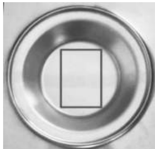
図 1. 水素透過試験サンプル (青印部分：50 × 120mm) を接写した写真
