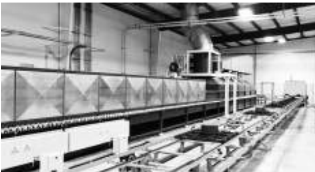
铸铁锅用辊道窑的冷却区
