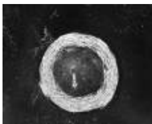
图2 使用相同熔块和颜料采用湿法工艺制成的样品的冲击试验结果。
