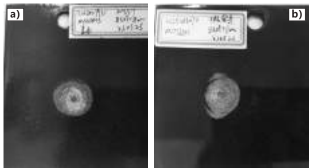
图 6 涂搪实验结果 :a) 湿法双面涂搪 ;b) 静电干法双面涂搪
