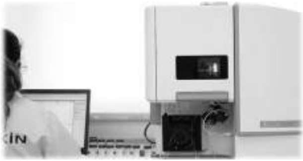
图 2. ICP-OES 分光光度计中的迁移分析
