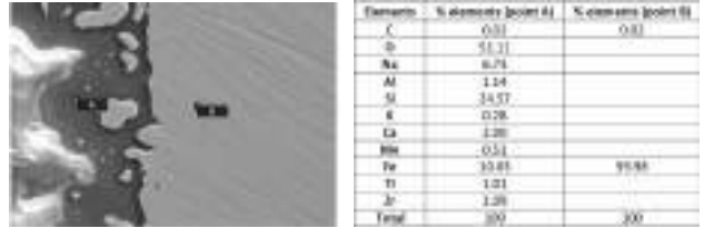
图1 显示釉料与金属粘界面电镜扫描。A位置与B位置的元素含量用EDS测量
