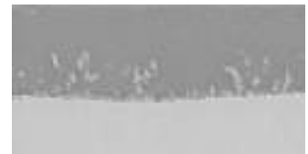
図4：明確なデンドライト形成がある鋼板とほうろうの界面の詳細とSEM分析
