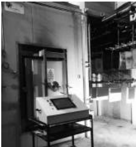
図 2: エレクトロラックス・フォルリ工場における HELIOS MAGMA ガス分析器による工業炉の雰囲気モニタリング。
