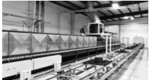
鑄鉄鍋用ローラーキルンの冷却部
