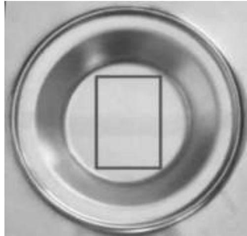
图 1 样品照片，选取中间蓝色区域做氢渗透试验 (蓝色标记区域：50x120mm)
