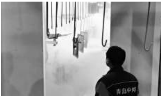
图1 静电干粉搪瓷喷涂
