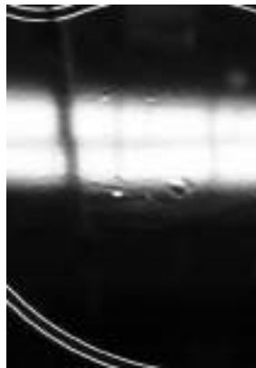
图 5 有粉团的零件烧成后缺陷
