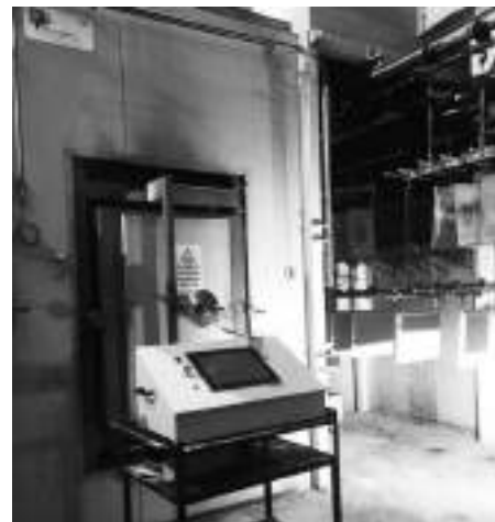
图 2：HELIOS MAGMA 气体分析仪在 Electrolux Forli 工厂进行工业炉膛气氛监测。
